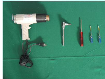
使用工具 ヒートガン、トルクスレンチ、プラスドライバー、 離型紙を巻いたマイナスドライバー×2
